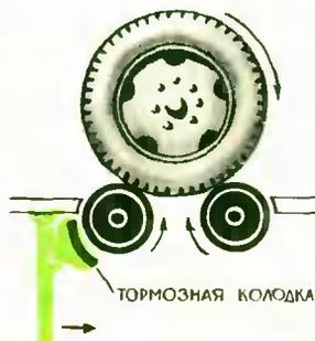
таки заметили, что автомобиль самостоятельно не сможет съехать с валков, отбирающих мощность с задних колес. Ребята предлагают своеобразный тормоз. Когда валки прижаты тормозной колодкой, машина съедет без пробуксовывания.
